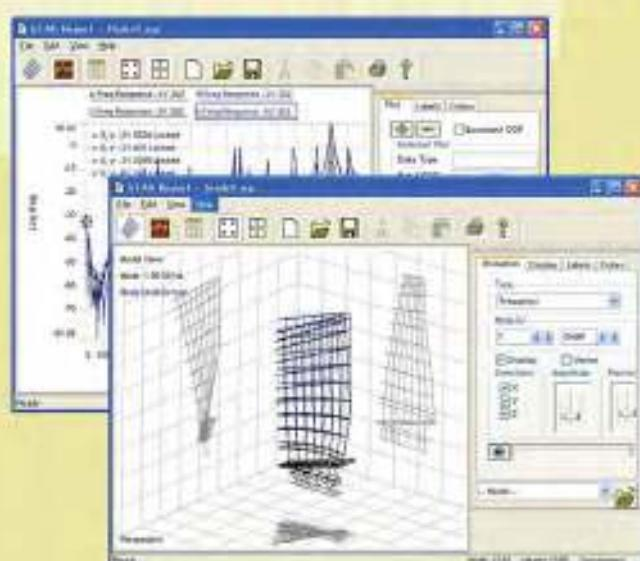
STARReport は、解析結果に関する実験レポート作成ツールとして、効果的な威力を発揮します。モードシェーブ・サーバーでは、モードシェーブ解析結果のライブ・アニメーション、3Dグリッド、投影シャドウ表示および回転、ズームなどの迅速なコントロールが可能です。ファンクション・サーバーでは、計測データトレースに関するカーソル・コントロール、フォーマットの選択、オーバレイ、セバレートなどの表示が可能です。
